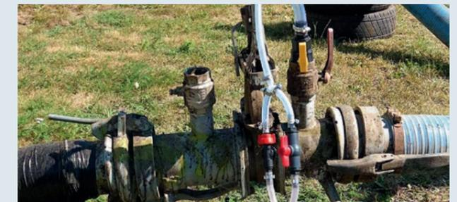
Zudosierung in den Ansaugschlauch
